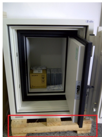
Vista do cofre aberto: destaque para o material combustível.
