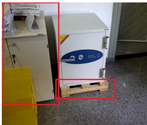
Vista do cofre fechado: destaque para o material combustível.
